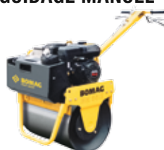
BW 55 E Poids en charge : 161 kg Force centrifuge : 10 kN Largeur utile : 560 mm
